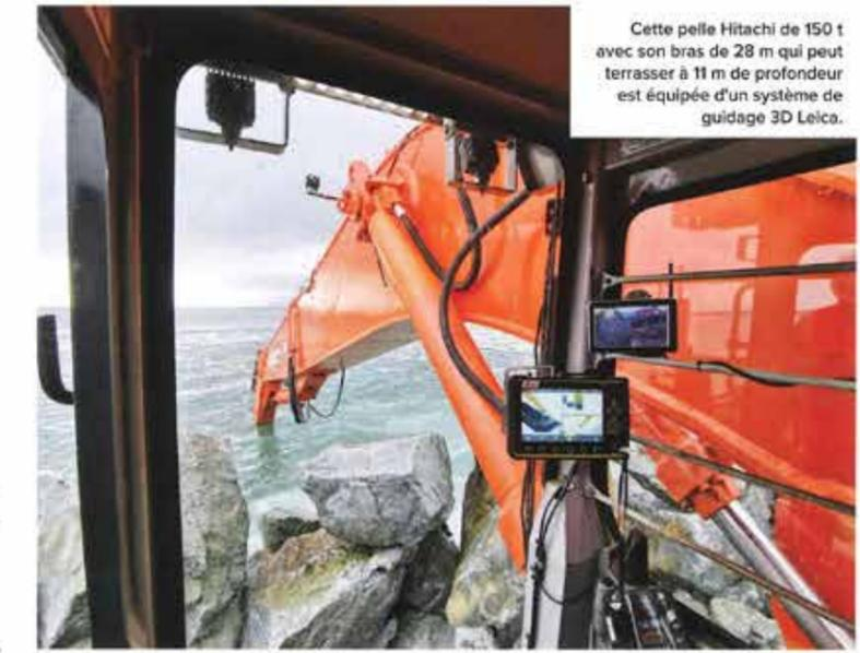
Cette pelle Hitachi de 150 t avec son bras de 28 m qui peut terrasser à 11 m de profondeur est équipée d'un système de guidage 3D Leica.
