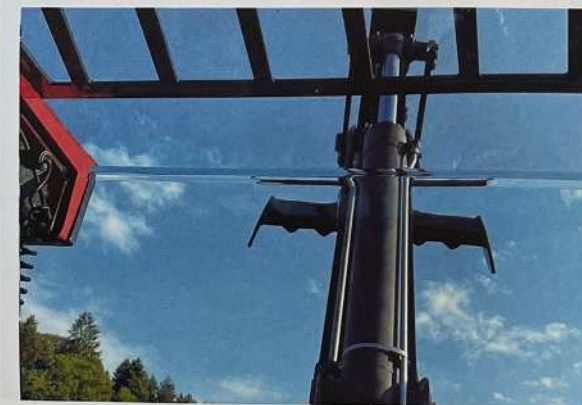
Châssis avec articulation centrale offrant une direction articulée du châssis de plus ou moins 45°. Ritter Maschinen GmbH
